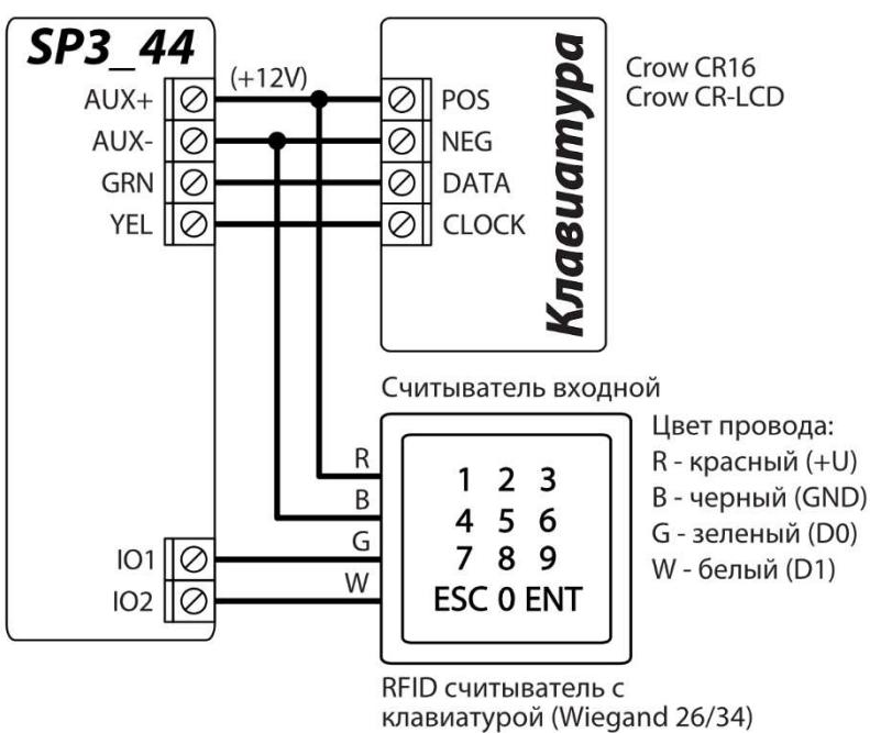
К охранной панели можно подсоединить до 2 RFID считывателей. Клавиатуры к охранной панели не подключаются, когда подсоединенены два RFID считывателя.
