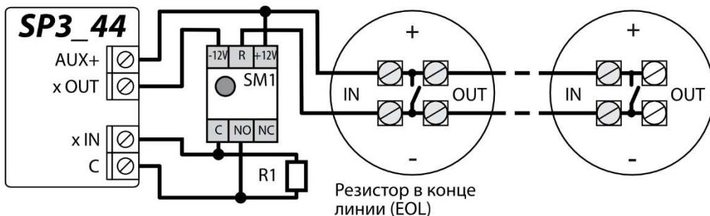
Подключение четырехпроводных пожарных извещателей.
