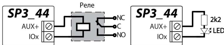
Различные электрические устройства могут управляться (вкл/выкл) удаленно с помощью контактов реле. Универсальная IO (вход/выход) клемма охранной панели должна быть установлена в режим работы Выход (OUT) и назначен тип Удаленное управление.
