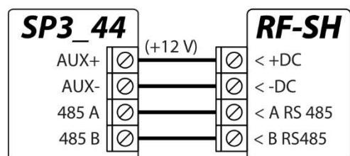
С модулем **RF-SH** к охранной системе можно добавить до 42 беспроводных брелоков, 16 беспроводных сирен, 32 беспроводных датчика, 8 беспроводных клавиатур.
