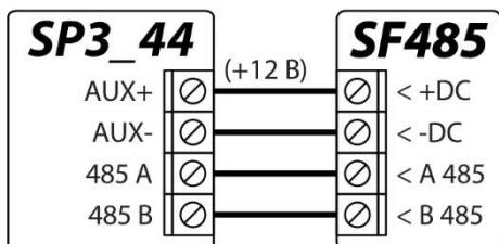
**SF485** действует как резервный канал связи для передачи событий охранной панели на ПЧН (пульт централизованного наблюдения) или в мобильное приложение **Protegus** по сети SigFox, когда события не могут быть переданы по **Основному** каналу связи. Сообщения передаются в формате Contact ID кодов.
