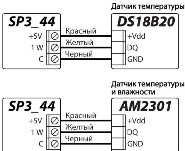
Датчики температуры подсоединяются по приведенной схеме. К охранной панели „FLEXi“ SP3\_44 можно подключить температурные датчики Maxim®/Dallas® DS18S20, DS18B20 (до 8 шт.) или датчик влажности и температуры AM2301 (1 шт.).
