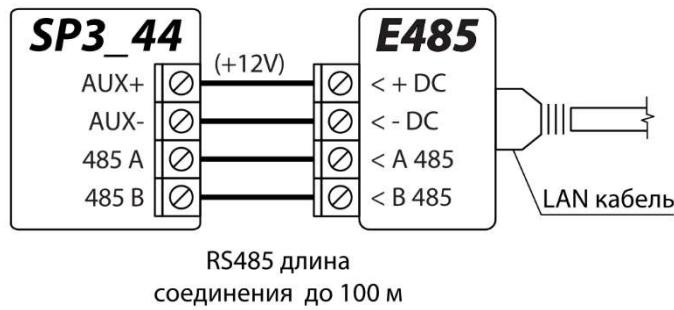
Модуль **E485** предназначен для передачи сообщений и управления через проводную компьютерную сеть. Используя **E485** вместе с охранной панелью, сообщения на ПЧН и в **Protegus** передаются через проводную компьютерную сеть и мобильный интернет не используется. При нарушении связи в проводной компьютерной сети данные передаются через сеть мобильного интернета. При восстановлении связи в компьютерной сети „FLEXi“ **SP3\_44** начинает вновь отправлять сообщения через **E485**.
