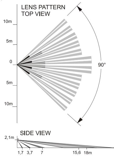
Rys. 2. Zakres detekcji, widok od góry i z boku
